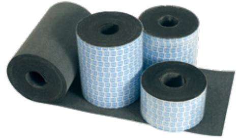
Icothene är ett självhäftande membran som består av kraftig polyetenfolie belagd med SBS-modifierad asfalt. Den används som glidskikt under tegelväggar och minskar risken för sprickor vid eventuella rörelser i konstruktionen.
